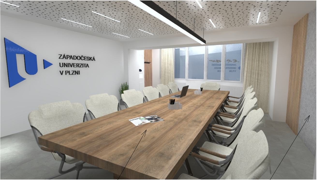
SOUČASTÍ STOLU BUDOU VESTAVĚNÉ VÝKLOPNÉ ZÁSUVKY NA PŘIPOJENÍ K EL A DATŮM - CELKEM 2X OMÍTNUTÁ STĚNA, IMITACE POHLEDOVÝ BETON
